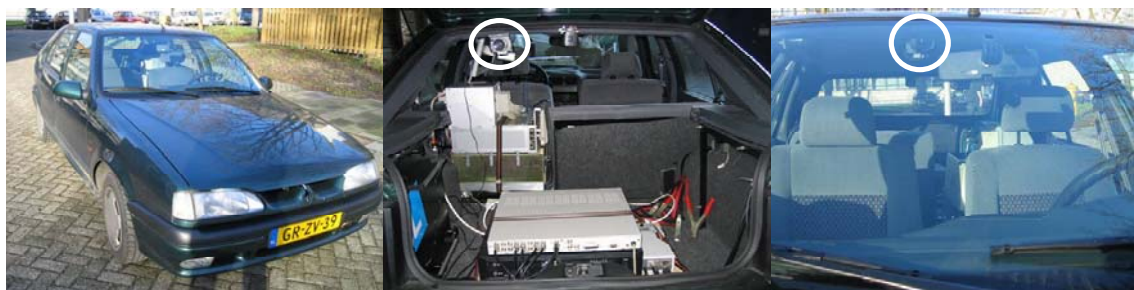
Figuur 2: Het geïnstrumenteerde voertuig met de cameraposities
