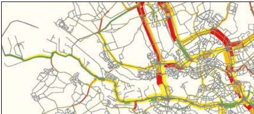
Figuur 8: Transumo A15, een overzicht van I/C waarden (intensiteit/capaciteit). Het betreft hier als voorbeeld de ochtendspits in een bepaalde scenario voor 2033.
