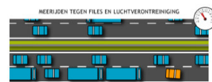
Figuur 5: De medewerkers laten het verkeer weer doorstromen zodra het verkeer tot rust is gekomen; de zo ontstane ruimte op de weg wordt benut. Dit wordt herhaald totdat de intensiteiten na een (spits)periode afnemen.
