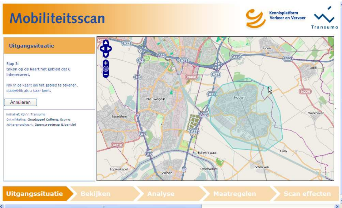
Figuur 2: De gebruiker omcirkelt het gebied waarbinnen analyses gewenst zijn. De scan aggregereert alle data buiten dit gebied. De rekestijd kan zo fors omlaag.
