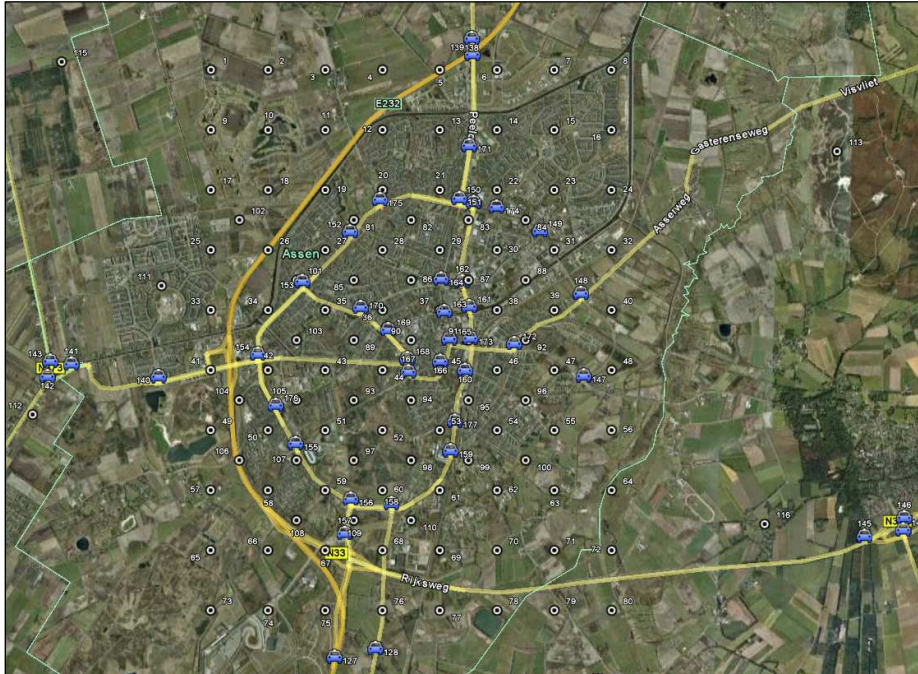
Figuur 3.1: Concept sensornetwerk, grid points en additionele locaties t.b.v. mobiliteit (bron: Google Earth)
