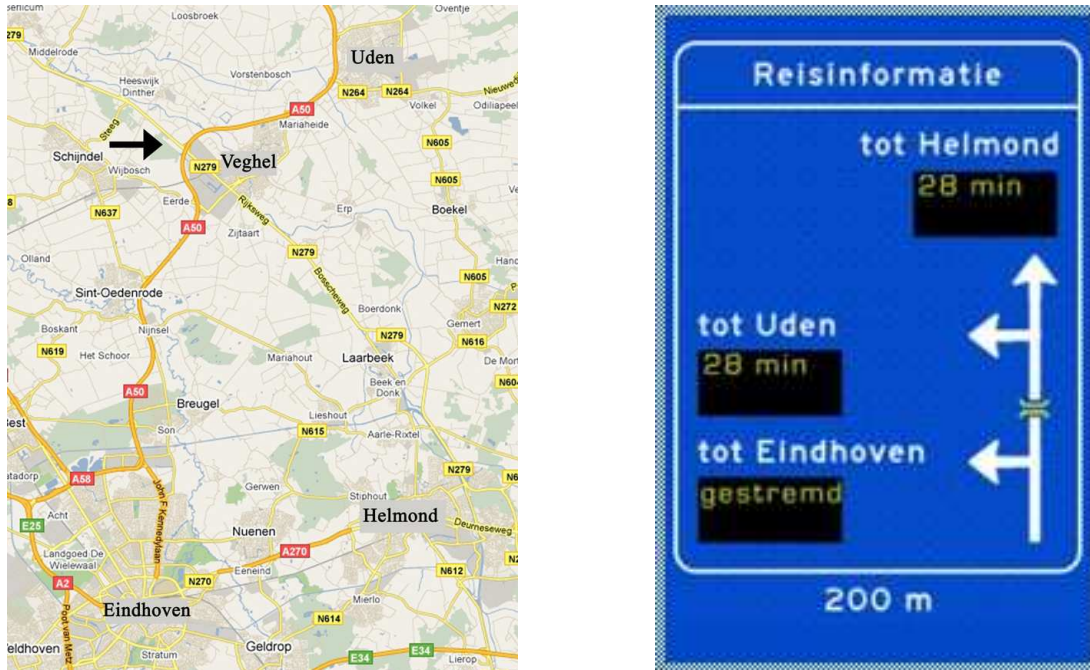
Figuur 7: Locatie van het DRIP bij Veghel; het DRIP is geplaatst vlak voor de oprit naar de A50. Daarnaast het DRIP.
