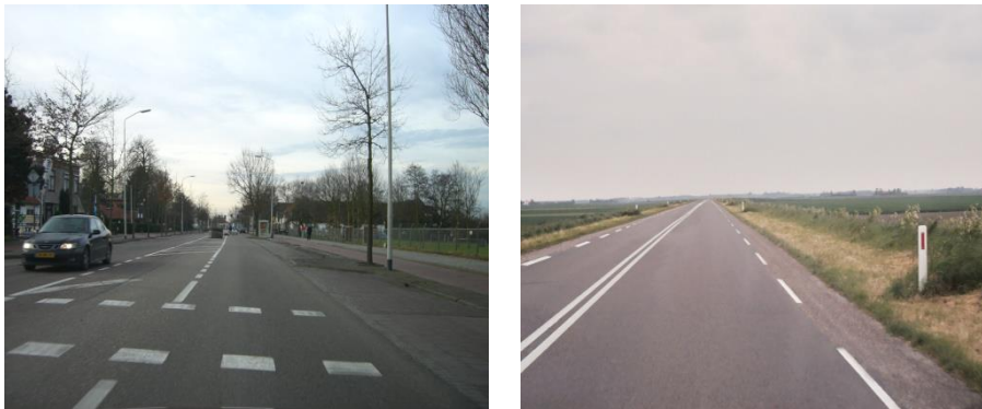
Afbeelding 2. Voorbeelden van wegen met veel versnellers: een open karakter, breed dwarsprofiel en lange rechtstand.
