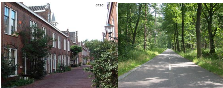
Afbeelding 3 Voorbeelden van wegen met veel vertragers: een gesloten karakter (dichte bebouwing), smal dwarsprofiel, korte rechtstand.
