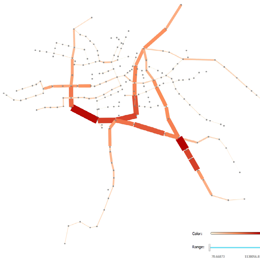
Figuur 5 Link Kritikaliteit per link in het spoorgebonden OV netwerk in Amsterdam geografisch weergegeven
