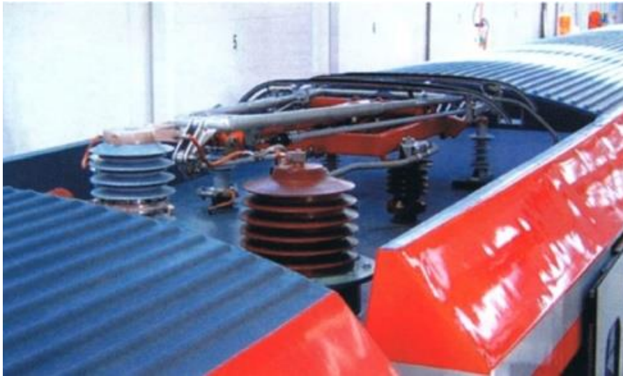
Figuur 4: Stroomafnemer 15 kV AC op het dak van de S-Bahn Hamburg
