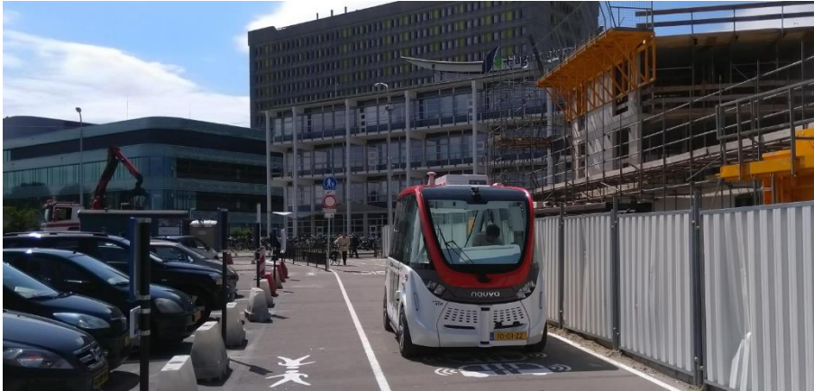
figuur 3: HAGA Shuttle op de route naar het ziekenhuis, afscheiding tussen voetgangers en de shuttle
