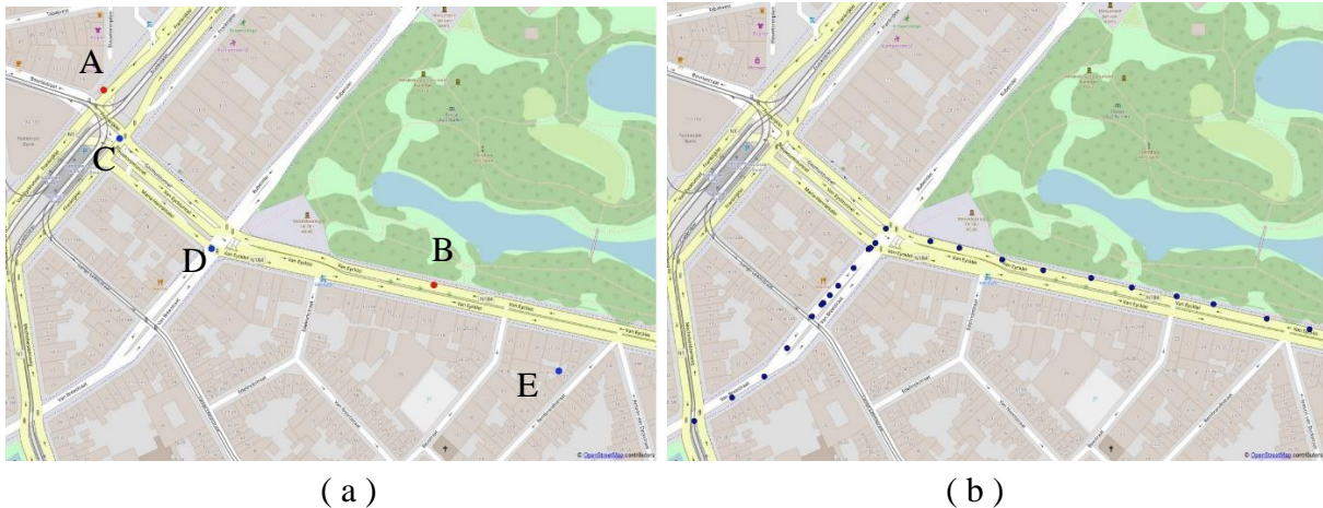
Figuur 1: Illustratie van ongunstige ligging van GPS-punten (a), te ver of te dicht bij het kruispunt. Dit probleem stelt zich niet bij een voldoende hoge frequentie van GPS-tracking (b)
