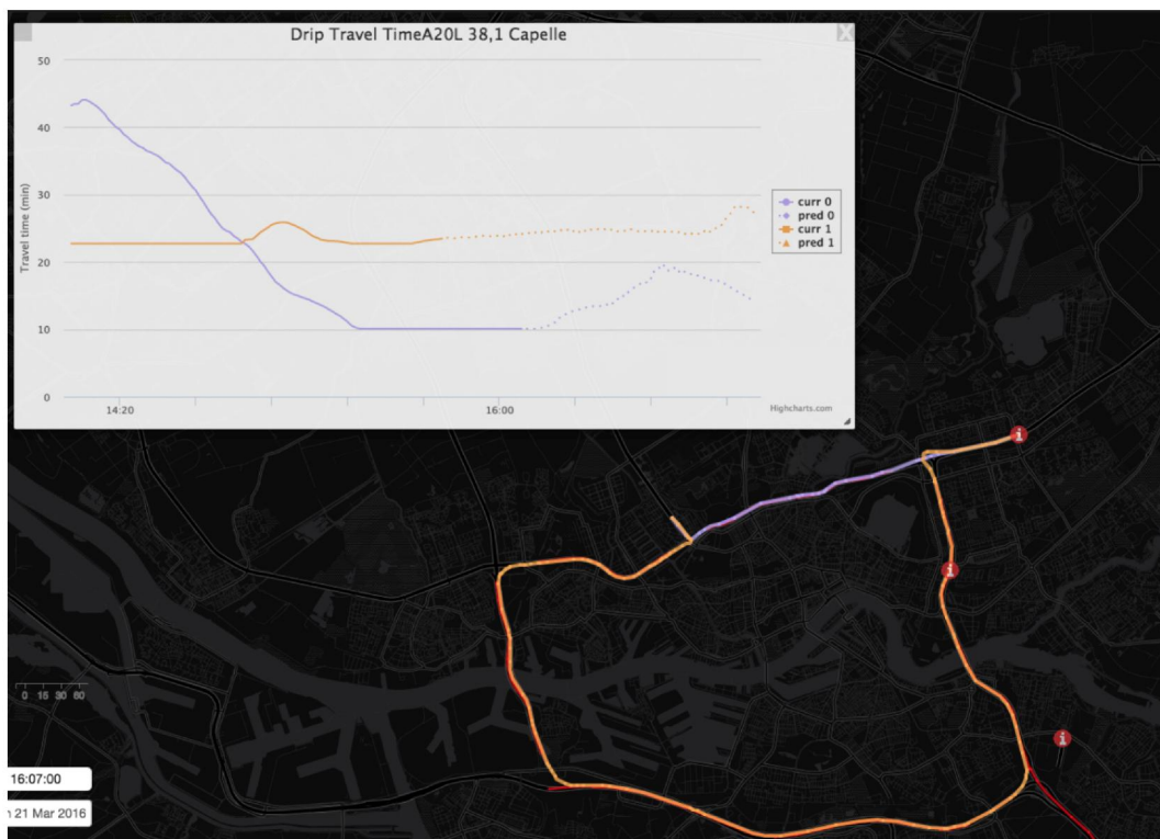
Figuur 2: Reistijden over twee routes ('normale' route en omleidingsroute). De doorgetrokken lijnen zijn recent gemeten reistijden, de stippellijnen de voorspelling. Als de paarse lijn in de voorspelling boven de oranje lijn ligt, wordt het instellen van een omleiding interessant.
