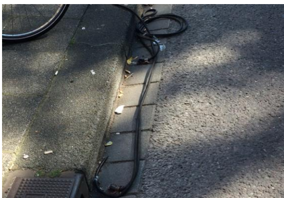
Figuur 2: Kwetsbare kanten van de telsing: links een losgeraakt exemplaar in het centrum van Amsterdam (foto: S. Valenta) en rechts een aangereden telapparaat in het Belgische Tessenderlo (foto: Meetel BV)
