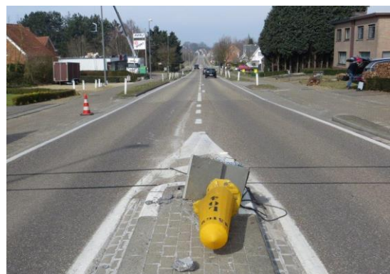
Figuur 2: Kwetsbare kanten van de telsing: links een losgeraakt exemplaar in het centrum van Amsterdam (foto: S. Valenta) en rechts een aangereden telapparaat in het Belgische Tessenderlo (foto: Meetel BV)
